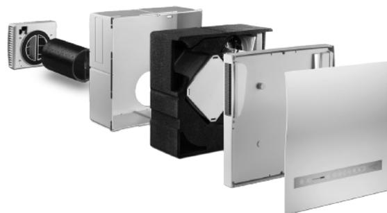
Es uno de los ventiladores descentralizados más pequeños, para uso residencial. La recuperación de calor se basa en el principio del intercambio de calor regenerativo. Mediante un flujo de aire invertido (en un intervalo de 70 segundos), que se produce por un cambio de dirección específico del ventilador, el material cerámico se carga con la energía calorífica del aire ambiente y lo devuelve al aire exterior suministrado.
