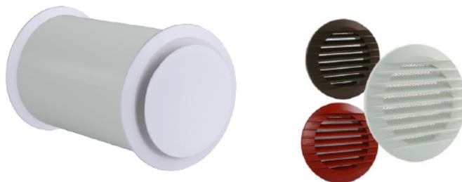
Equipo de ventilación pasiva sin ventilador que funciona al permitir entrar aire cuando otro equipo de extracción produce una baja de presión al extraer aire del hogar. El ALD-R160 es utilizado principalmente en situaciones que es requerida una gran comodidad y aislación contra el frío y el ruido exterior. Con este equipo es posible utilizar el filtro de polución o de polen según sea necesario.
